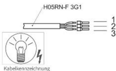
Zuleitungskabel 3 x 1 mm<sup>2</sup> mit offenem Ende
